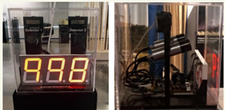
FIGURA 2. VISTAS FRONTAL (IZQUIERDA) Y LATERAL (DERECHA) DEL CONTADOR GEIGER DE LA SALA DE VISITAS (CRÉDITO: OBSERVATORIO PIERRE AUGER).
