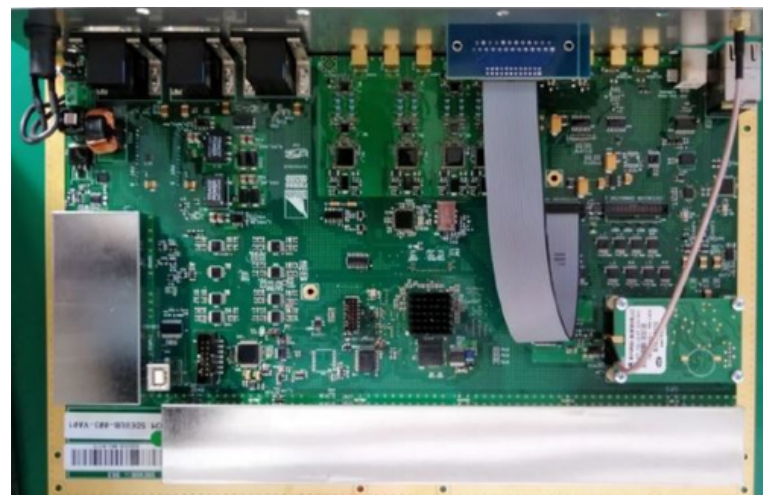
Fig. 2 Unidad UUB ensamblada, equipada con panel frontal, receptor GPS, cables y cubiertas de blindaje.
